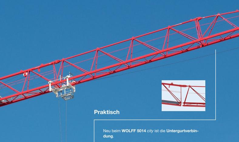
Durch die spezifische Bauweise werden kleinere Bolzen eingesetzt – was die Montage des Auslegers vereinfacht.
