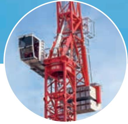
Der WOLFF Wipper ist effizient, platzsparend und auf beengten Baustellen in seinem Element. Wie jeder WOLFF Kran ist er besonders leicht zu transportieren und zu montieren: Dafür sorgt die patentierte Bauart des aufgelösten Fachwerks mit extrem kompaktem Gegenausleger und kompakter oberer Turmspitze.
