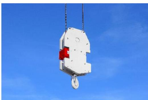
Le système d'assistance HiSPS fonctionne à l'aide de deux capteurs alimentés par batterie sur le chariot et la partie inférieure du boulet, soit du crochet de grue. Reliés à une unité de commande dans l'armoire électrique, les capteurs détectent les mouvements du câble et adaptent automatiquement le mouvement et la vitesse des mécanismes de rotation et de translation du chariot.
