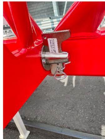
Statt mit einer Bolzen Verbindung, werden die Auslegerstücke mit einer Dorn- und Keilverbindung an der Stirnseite montiert.
