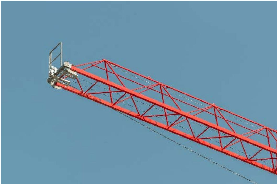
Die Seilwirbeltraverse an der Spitze (oben) hat durch das neue Untergurtdesign eine Dorn- und Keilverbindung und ist so leichter zu montieren. Geländer und Laufgitter sind verzinkt und damit besonders robust und langlebig.
