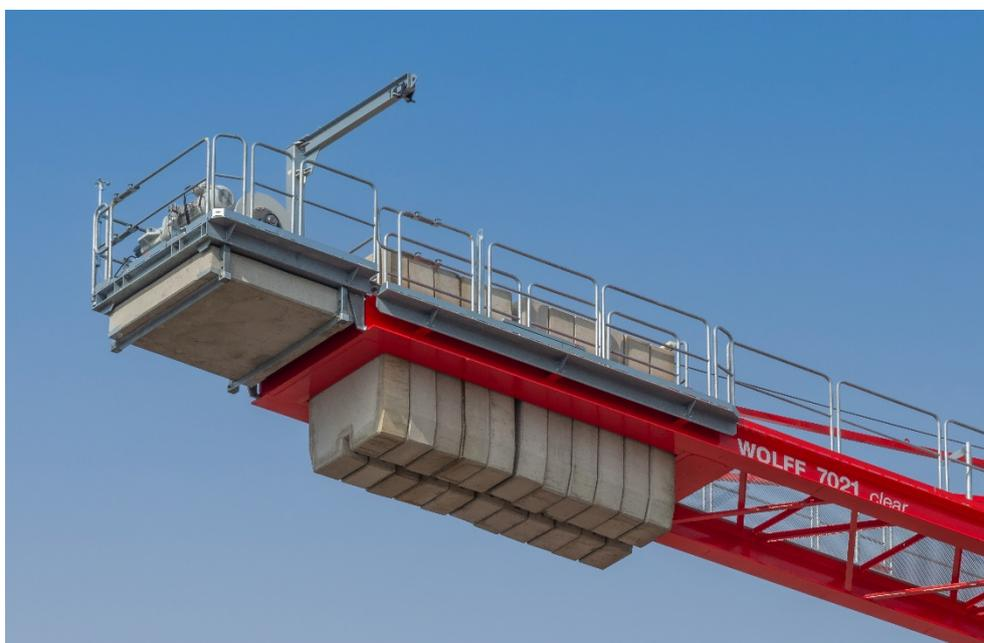
Le cadre de lestage redessiné pour le treuil de levage se monte facilement et s'enlève très facilement pour le transport grâce à une connexion rapide. Les garde-corps ont également été redessinés. Ils sont plus légers et restent en place pendant le transport. La grue auxiliaire en option sur le treuil de levage facilite l'entretien.
